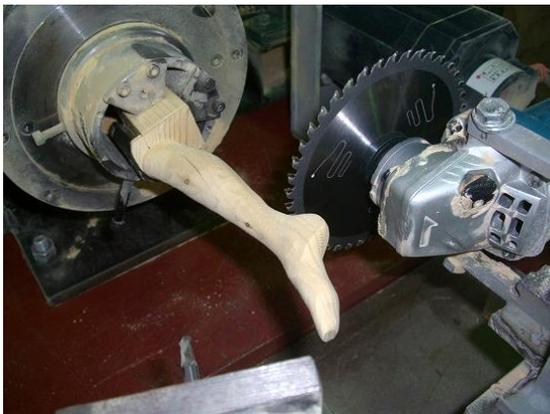
写真1 チップソーを用いたCNC木工旋盤
