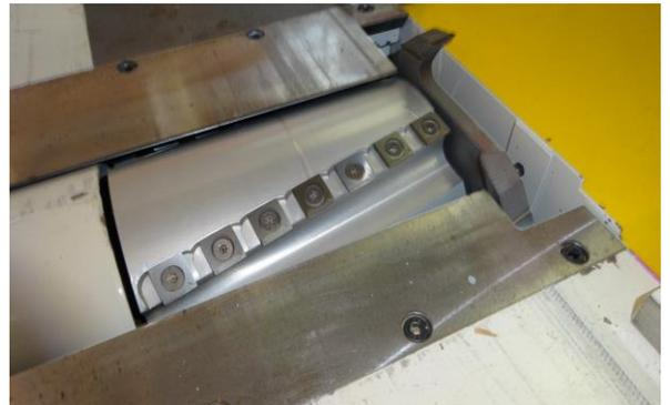
図3 替刃式ラフィングスパイラルカッターとそば取りカッター
