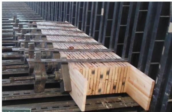
写真1 クランプを使用した圧縮
