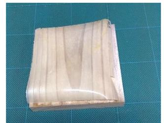
図5 暴露後の塗膜のはく離
