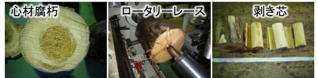
心材腐朽ではロータリーレースの回転軸が丸太を保持できず、空回りする丸太もありましたが、腐朽のない単板が多く採れました。
