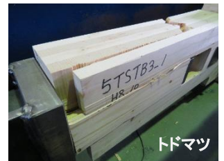
図4 縁距離が不足している場合の破壊形態
