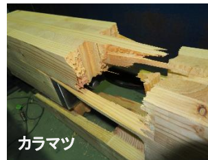
図4 縁距離が不足している場合の破壊形態
