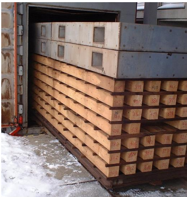
写真1 栈積みの様子(蒸気式)
