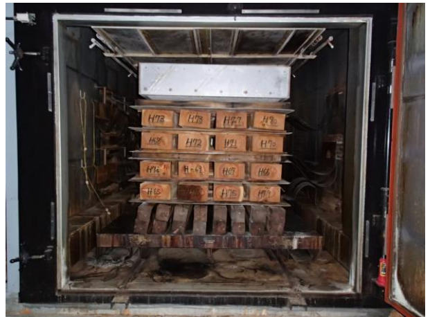
写真2 棧積みの様子（蒸気・高周波加熱式）
