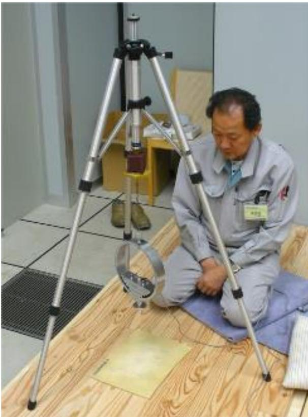
写真2 転倒衝突時硬さ試験
