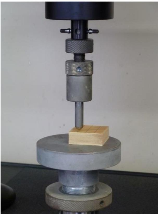
写真1 表面硬さ試験の様子
