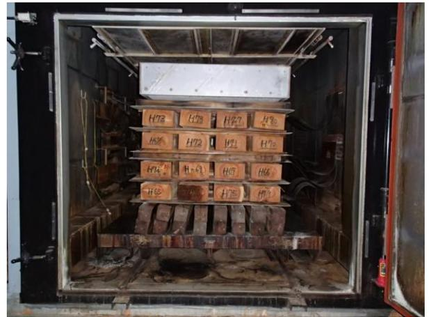
写真2 棧積みの様子（蒸気・高周波加熱式）
