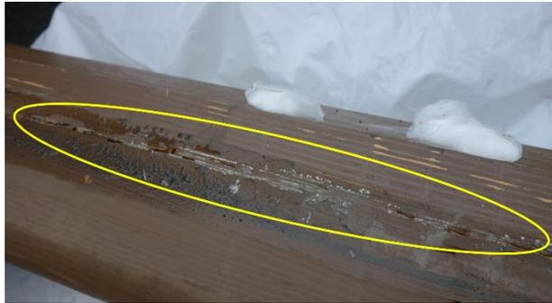
写真4 実用化製品に発生した腐朽部位
