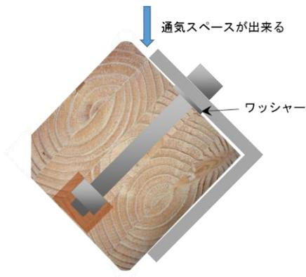
図3 ワッシャー挿入による通気の確保
