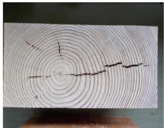
写真2 乾燥により生じた内部割れ
