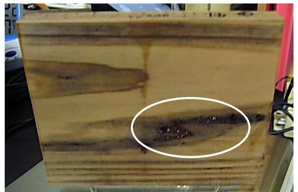
写真3 無塗装試験体に発生した水滴の一例
