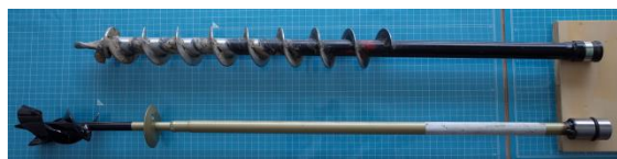
図4 一般的なオーガ(上)と改造したSD-60(下)
