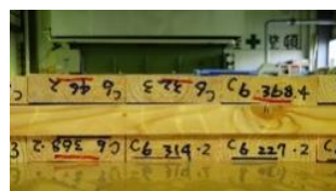
図2 プレス前のラミナのねじれ
