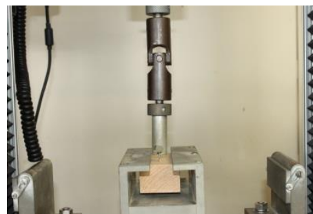
写真2 木ねじ引き抜き試験
