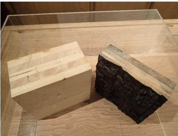
写真2 燃焼試験後のCLT
