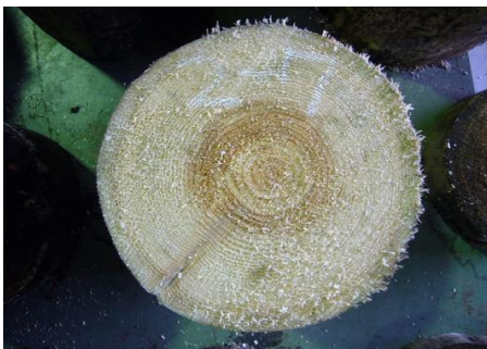
【心材腐朽の一例】
