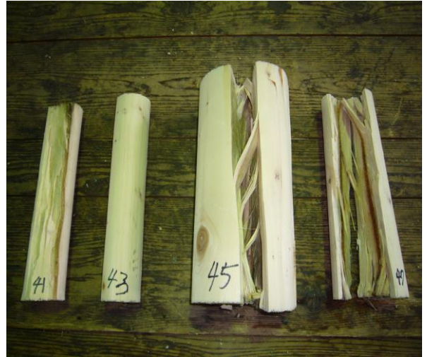
【辺材腐朽ドロマツ】
