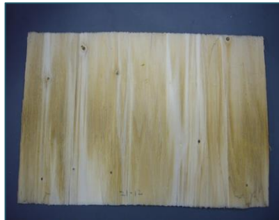
図5 ロータリーレースにより切削された単板
