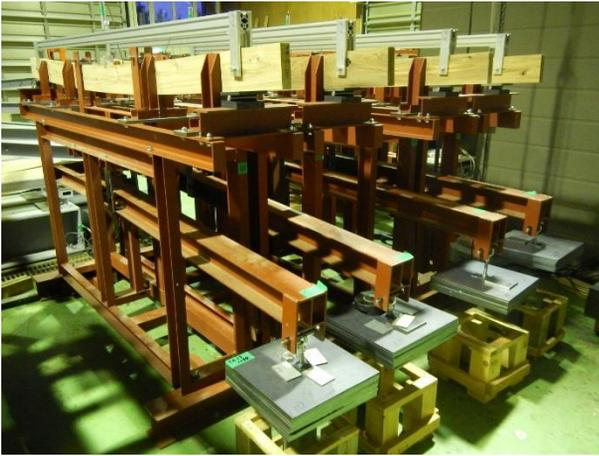
写真1 テコ式荷重装置（上面で変形測定）
