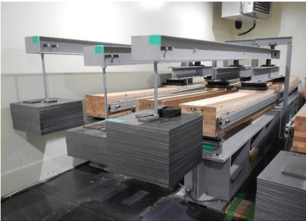
写真2 テコ式荷重装置（側面で変形測定）
