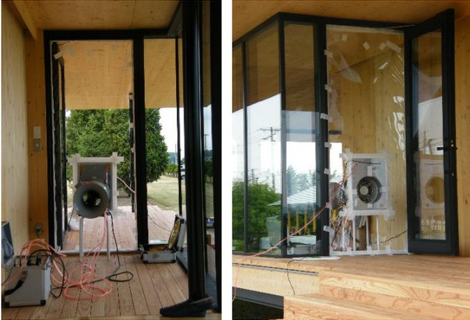
写真3 送風機設置状況（左：室内，右：屋外）
