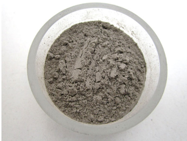
写真1 木質ボイラーから排出される燃焼灰の例
