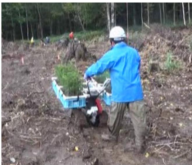
写真2 運搬機による林地内の運搬
