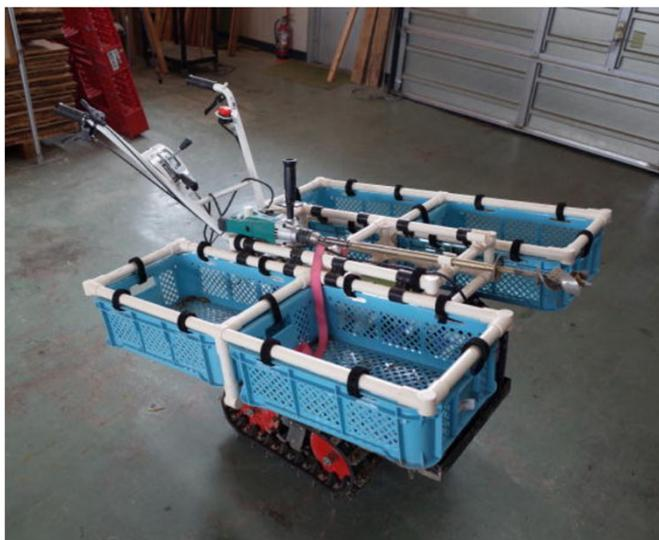
写真1 コンテナ苗運搬機
