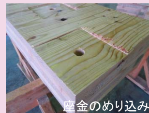
座金のめり込み試験
