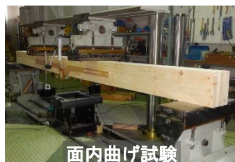
図2 短期強度性能試験の一例
