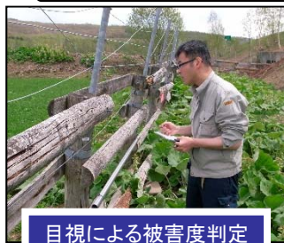
ピロディンの打ち込み 深さ(Pe値)の測定
