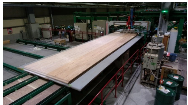
写真3 大判マザーボードの製造
