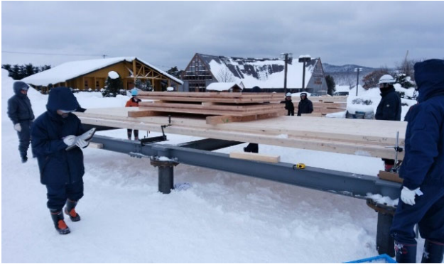
写真5 CLTパネルの曲げ剛性の測定
