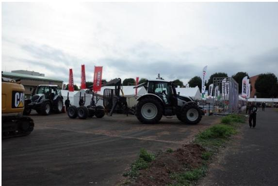
写真3 農業用トラクタで牽引する集材機械
