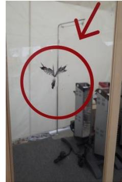
写真5 風防の飛散物安全試験
