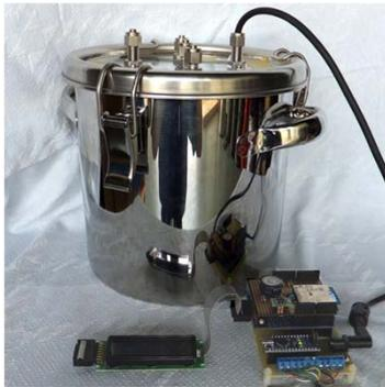
図2 試作した electronic nose
