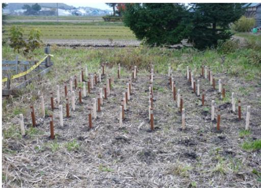
写真2 暴露試験地に設置した試験体
