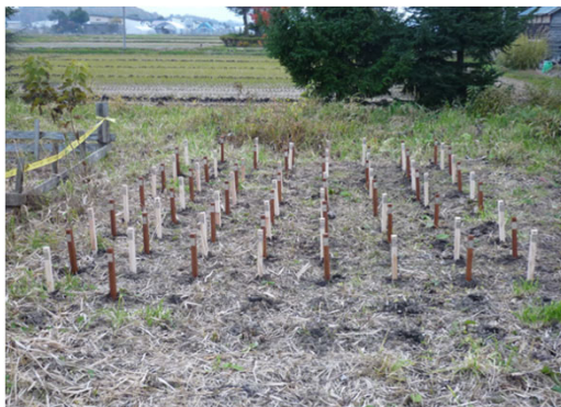
写真2 暴露試験地に設置した試験体
