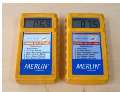
写真2 高周波式木材含水率計 (左: 5～8mm用, 右: 13～25mm用)
