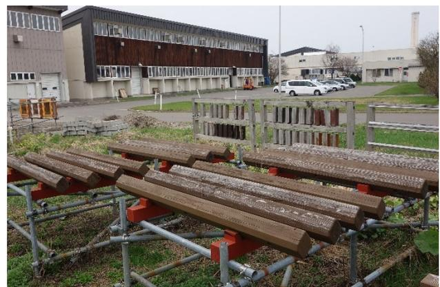
写真4 屋外曝露の様子 (ビスタガード) (V)
