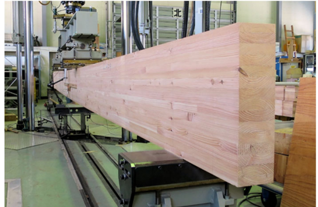
写真1 集成材の曲げ強度試験 スパン：8,100mm、断面：120×450mm（15ply）
