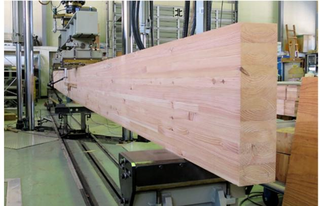
写真1 集成材の曲げ強度試験
