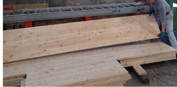
図3 幅はぎ接着されたラミナ
