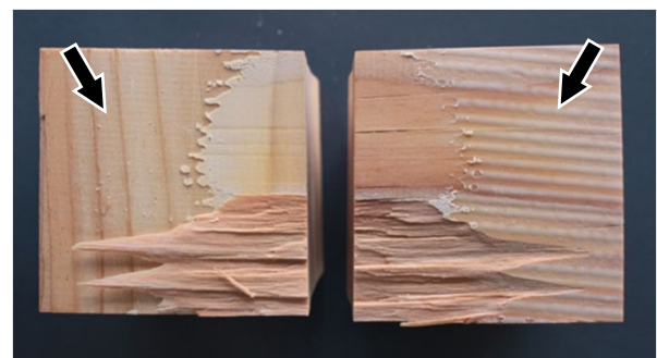
図5 接着不良が発生した接着層を割り開いた両断面
