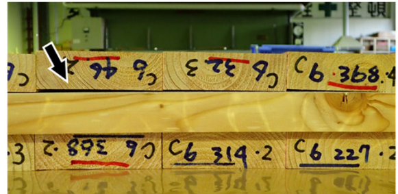
図6 ねじれの大きいラミナを用いたカラマツCLTにおける圧縮前の側面の様子。 (ねじれのため、ラミナ同士が密着せずに隙間がある。)
