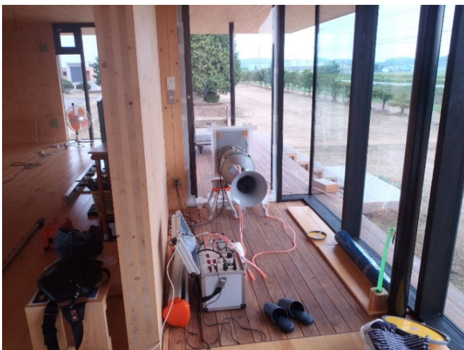
写真2 送風機設置状況
