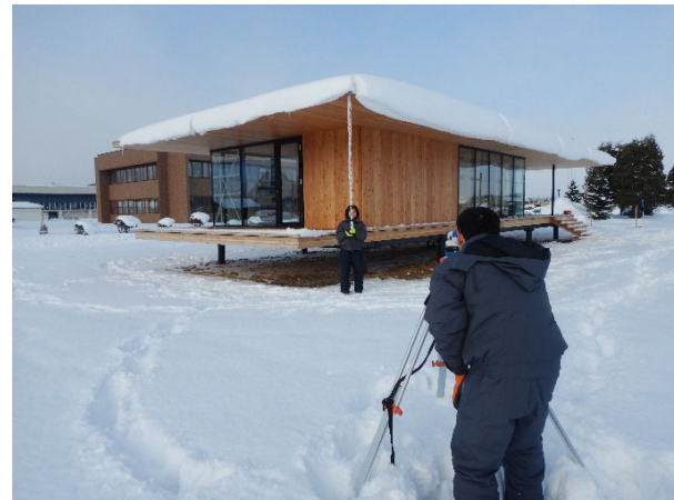
写真2 たわみ測定の様子
