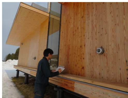
図6 壁パネルの耐候性評価
