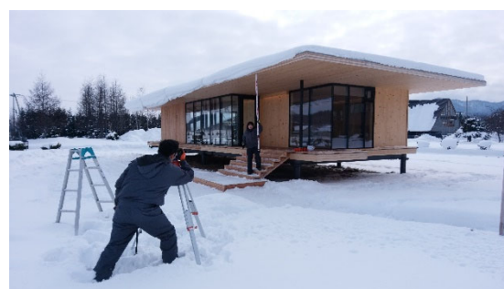
図4 屋根パネルの変形測定
