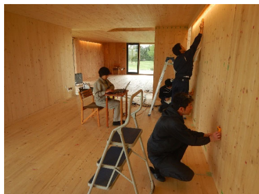
図5 壁パネルの表面形状測定
