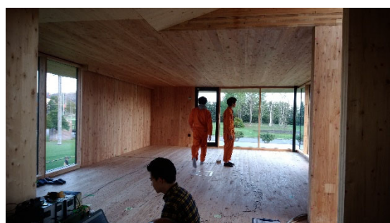
図2 床パネルの歩行振動試験
