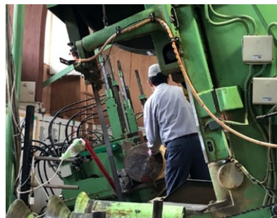
傾斜型送材車付き帯のこ盤
