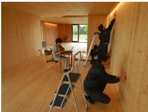
図5 壁パネルの表面形状測定
