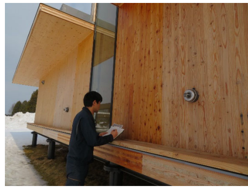
図6 壁パネルの耐候性評価
