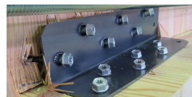
直径8.0mmビス：破断せず
