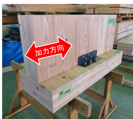
試験体（L型せん断金物）
