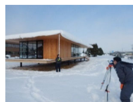
図3 たわみ測定の様子
