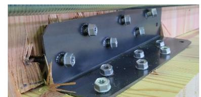
直径8.0mmビス：破断せず
