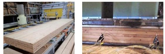
(a) 高周波プレス試験 (b) 接着層温度の計測
