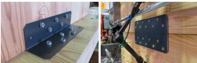
1) L型金物(壁-床接合部) 2) せん断金物(壁-壁接合部)
