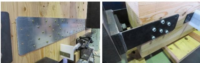
3) 帯金物(壁-壁接合部) 4) 引張金物(壁-基礎接合部)
