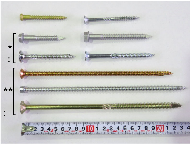
写真6 様々な形状の構造用ビス (*: 大径ビス, **: 長尺ビス)
