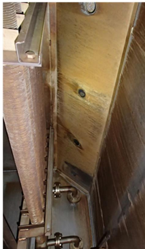
写真9 上部整流板の通気孔
