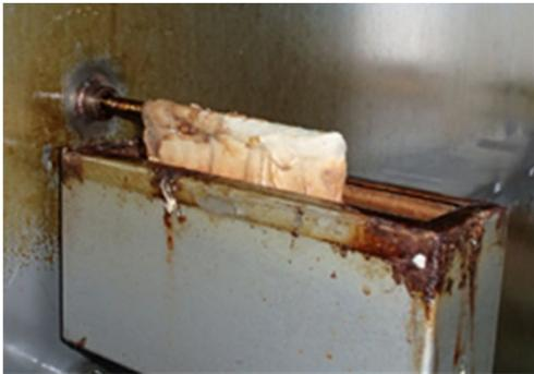
写真10 汚染した湿球センサーのガーゼ
