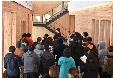
【1階通路は道産スギ材の壁】
