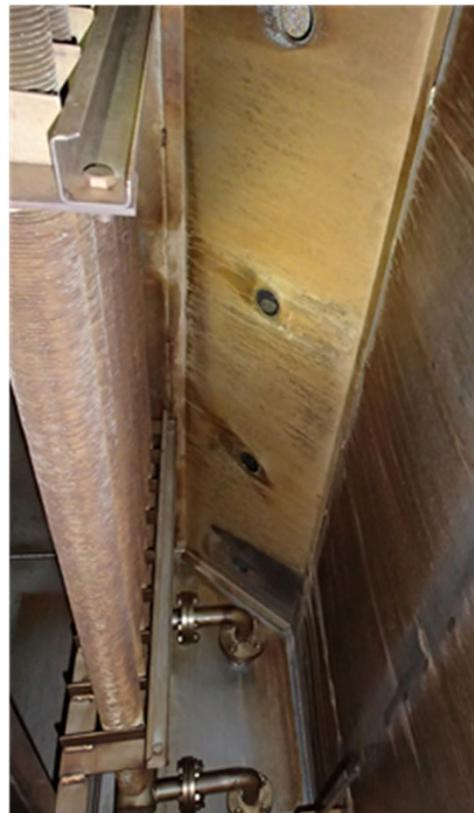
写真9 上部整流板の通気孔
