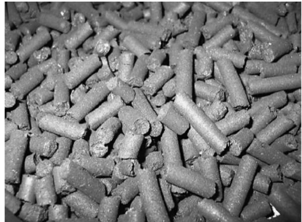
図1 木炭くず混合ペレット<sup>4)</sup>
