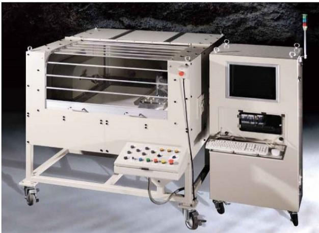
写真1 実用化されたCNC木工旋盤
