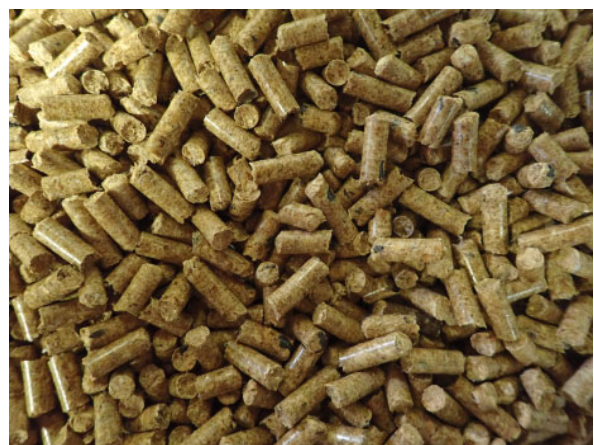
図2 農業用廃プラスチック混合ペレット燃料 （廃プラスチック10%混合、発熱量22.14MJ/kg）
