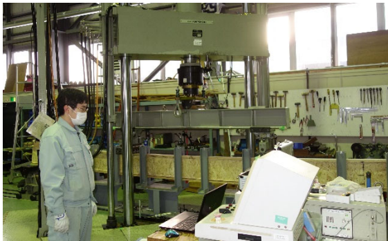
【実大部材の強度試験の様子（構造試験室）】
