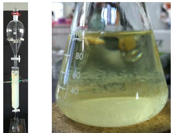
図6 シリカゲルカラムクロマトグラフィーの溶媒溶出（左），溶出液の分取と結晶の析出（右）
