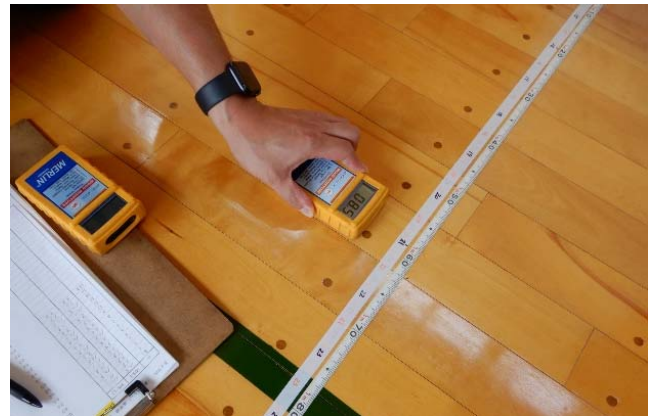
写真3 フローリングの含水率の測定 (幅方向)
