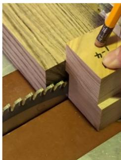
写真1 刃の厚さも考えながら5mmのずれをつくる。
