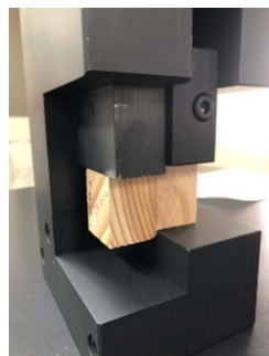
写真2 いす型の試験体を破壊する林産試験場独自開発のせん断試験装置
