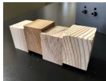
写真3 左側は繊維方向が直交している試験体（図1左）。手前右側は、繊維方向を45°傾斜させた試験体（図1右）。
