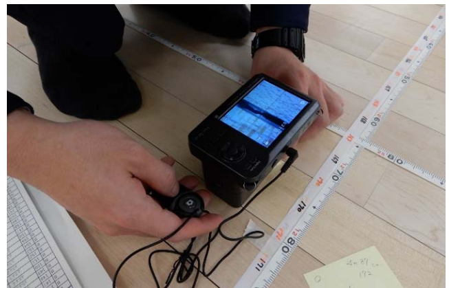
写真4 デジタル顕微鏡カメラによる目地幅の撮影
