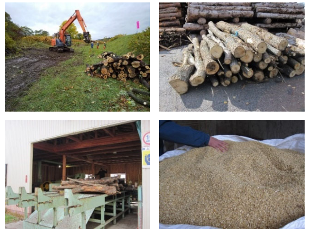
図4 伐採後のヤナギ原木によるおが粉製造 上左:伐採現場 上右:加工場に運搬された原木 下左:おが粉製造機への投入 下右:製造おが粉
