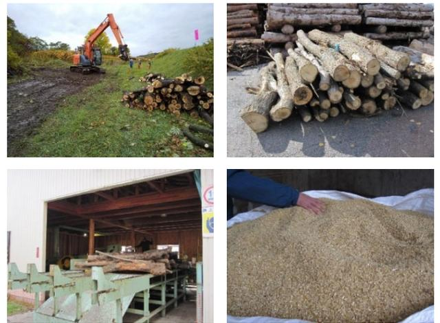
図4 伐採後のヤナギ原木によるおが粉製造
