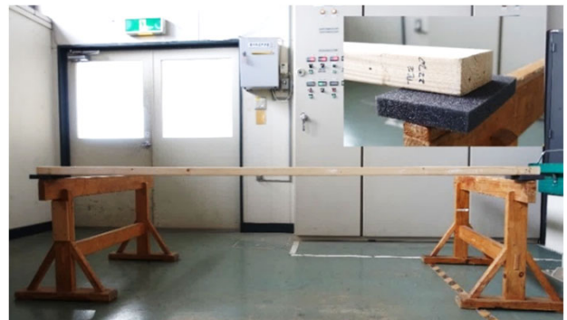
写真2 試験体の設置
